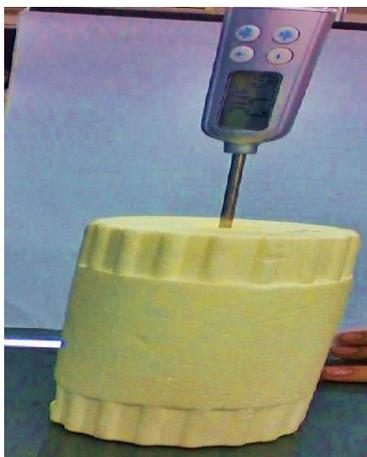
Figura 1 – Calorímetro construído. Fonte: Autores.
