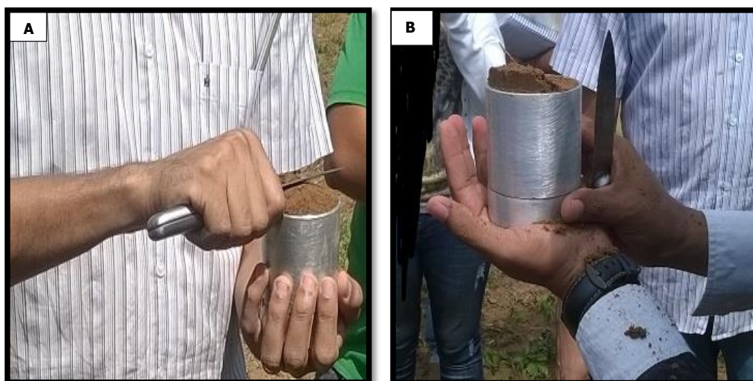
Figura A e B - Retirada do excesso de terra na lateral e correção das extremidades do cilindro.
